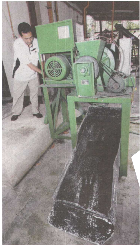
Kerja-kerja pemprosesan menggunakan mesin pengisar untuk menghasilkan fiber yang lebih halus.
